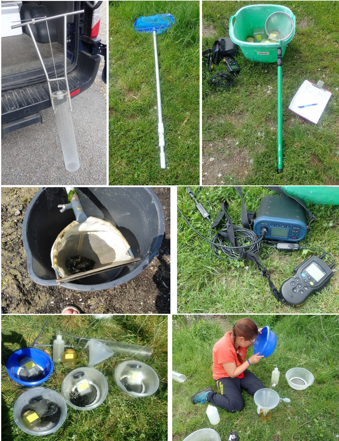
Abbildung 2: Probenahme-Geräte (Bild 1: Stechrohr, Bild 2: Schiebekescher, Bild 3: Siebkescher, Bild 4: Pfahlkratzer, Bild 5: Sauerstoff-, Salz-, Temperaturmessgeräte, Bild 6, 7: Siebe, Trichter, Spritzflaschen, Gefäße).
