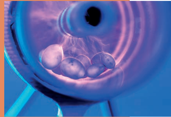
Lupinensamen während der Behandlung in einem Plasmareaktor. Foto: INP
